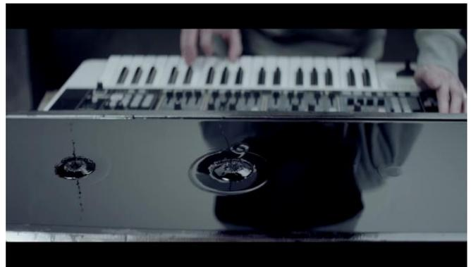
Le tube de Rubens, visible à partir de 3 min 35 s environ, permet d'illustrer visuellement la longueur d'onde d'un son. C'est une sorte d'oscilloscope primitif. Il suffit d'alimenter en gaz combustible un tube percé sur toute sa longueur et de placer un haut-parleur sur l'une des extrémités. Le tube alors va générer une onde stationnaire qui, avec les vibrations du son, fera danser les flammes.
